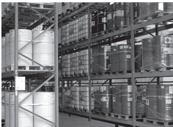
Obrázek 102: Pohled na správné skladování chemických látek v malých obalech. Látky jsou uskladněny podle chemické nebezpečnosti v regálech s požadovanou nosností a uskladněné látky jsou popsány. (foto: Spolek pro chemickou a hutní výrobu, a. s.).
