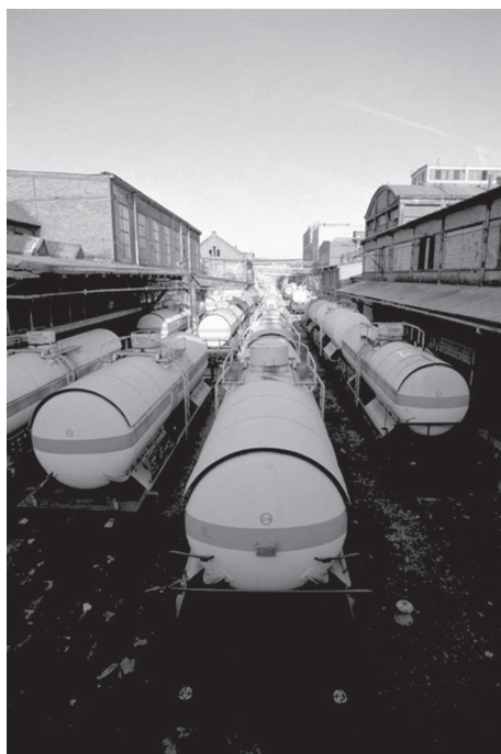
Obrázek 101: Pohled na železniční cisterny určené pro přepravu zkapalněných plynů. (foto: Spolek pro chemickou a hutní výrobu, a. s.).
